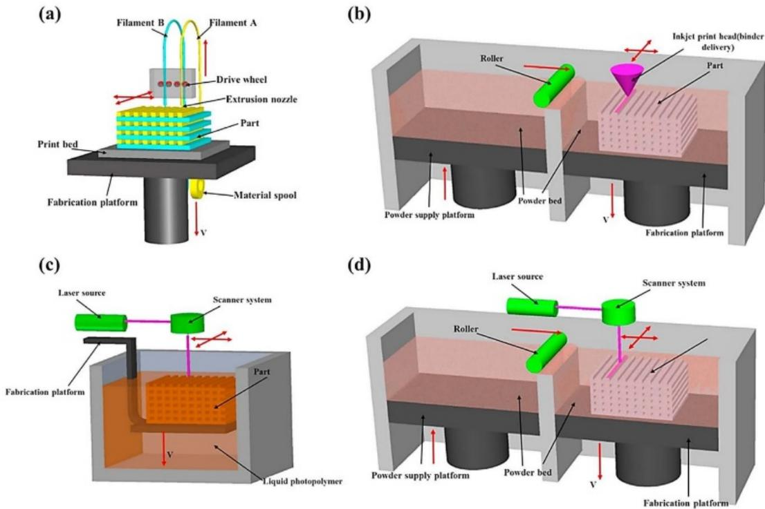
**Figure 3:** Four main methods of AM: (a) FDM; (b) inkjet printing; (c) SL; (d) PBF [13].
